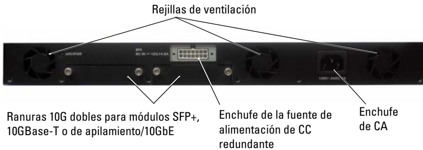
Ilustración 1-9. Panel posterior de PC7024P y PC7048P
