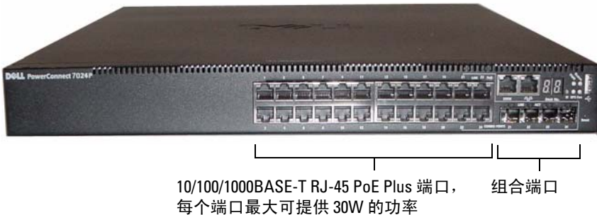
图 1-2. PowerConnect 7024P，具有 24 个 10/100/1000BASE-T PoE Plus 端口
